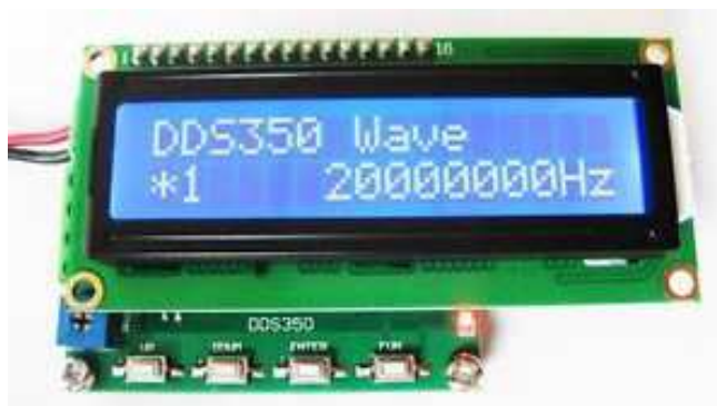
Photo 4 : Générateur DDS utilisé, basé sur un AD9850
