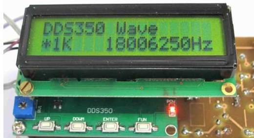
Photo 6 : Avec le générateur DDS réglé sur 18,006 250 MHz, la balise fonctionne sur 144,050 MHz
