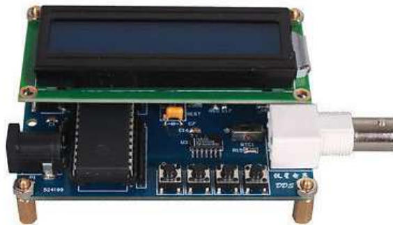
Photo 3 : Générateur DDS fonctionnant avec un circuit AD9851
