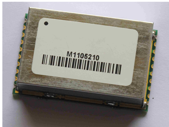
Photo 2 : Module qui équipe certaines balises 406 (Sce A. RF) Le module intègre l'oscillateur 406 TCXO, le modulateur PSK et l'amplificateur 5W.
