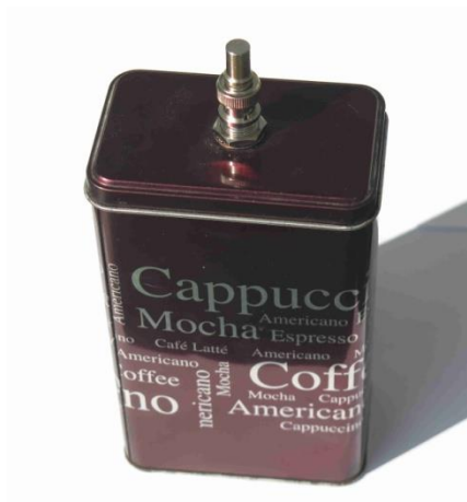
Photo 6 : Balise BPSK fonctionnant sur la fréquence 406,028 MHz La puissance émise est de 1 mW.
