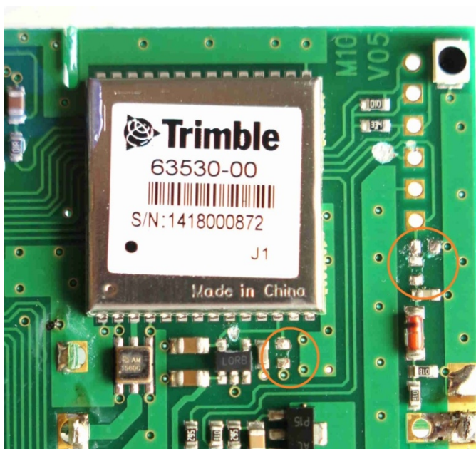
Photo 4 : Les 3 composants CMS à enlever, encerclés en orange
