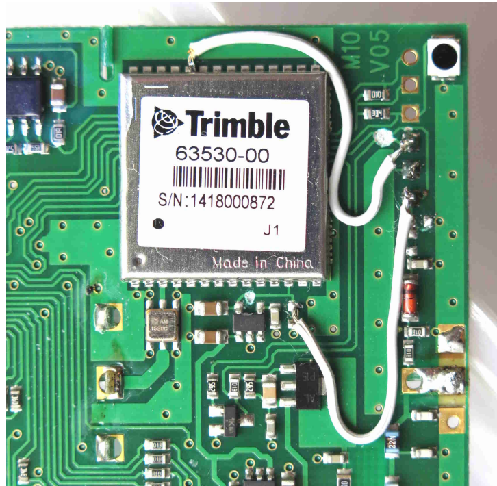
Photo 5 : Les liaisons entre le connecteur 3 broches à ajouter et le module Trimble
