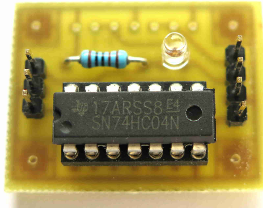
Photo 6 : Le module d'interface. Seule la partie 5 V → 3 V est câblée.
