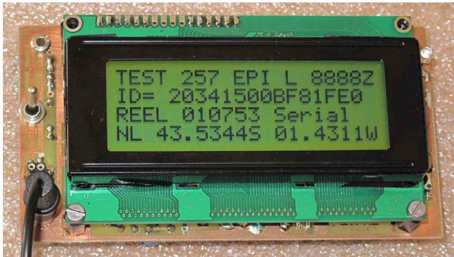
Photo 3 : le système monté et opérationnel, après réception d'une trame de test issu du site de F6HCC [3]
