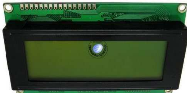
Photo 2 : Afficheur 4 lignes de 20 caractères, identification : "HD44780 20X4 Character LCD Display Green backlight 1pcs" de chez Chinaproduct" ou équivalent.
