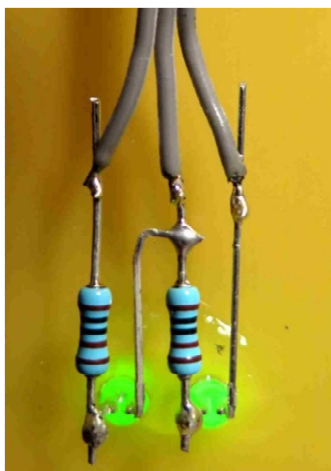
Photo 3 et Figure 3 : Les 2 LED et les résistances de 1 k \Omega
