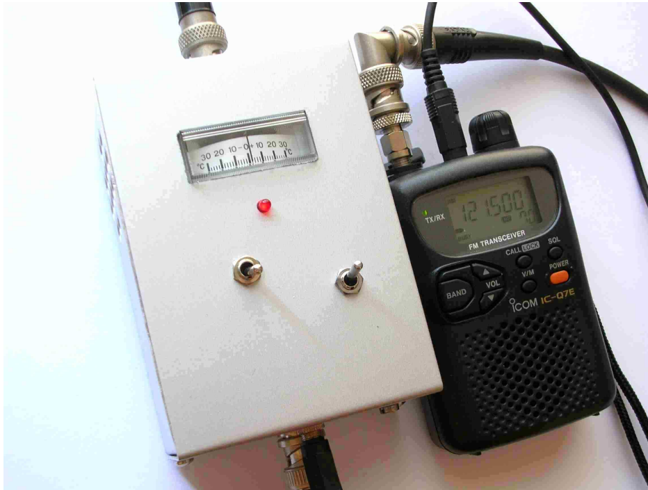
Photo 2 : Un autre exemple de montage du TDOA de WA7ARK associé à un ICOM IC-Q7, et test en Homing sur 121,5 MHz
