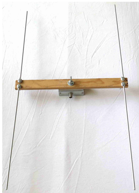
Photo 7 : L'antenne Homing VHF avec son boîtier de commutation pour 121 MHz. L'espace des dipôles est de 60 cm.
