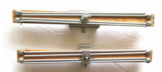
Photo 6 : Deux exemples d'antenne Homing repliée, taillée pour 200 MHz (120 MHz – 250 MHz)
