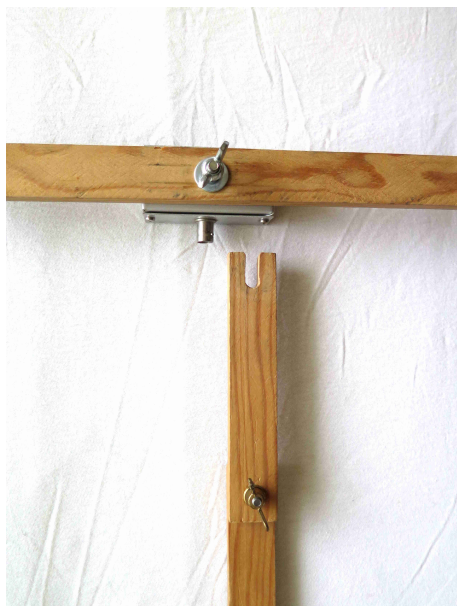
Photo 13 : Montage du support d'antenne (bras horizontal) sur le mât vertical.
