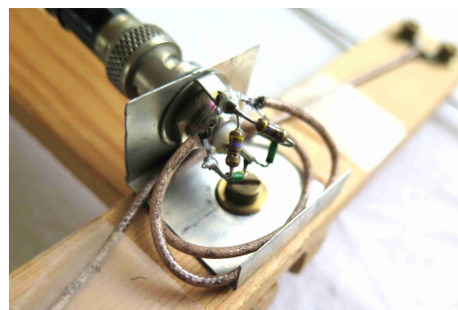
Photo 12 : Boîtier de commutation de l'antenne 400 MHz
