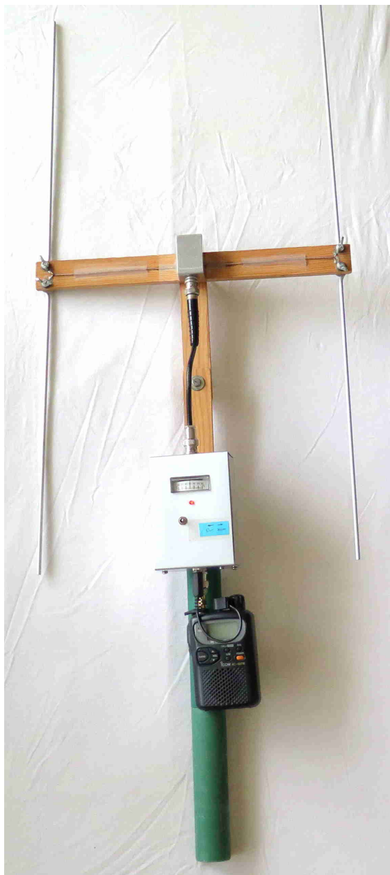
Photo 5 : « Homing Toutes Bandes » avec son antenne 200 MHz (120 MHz – 250 MHz)
