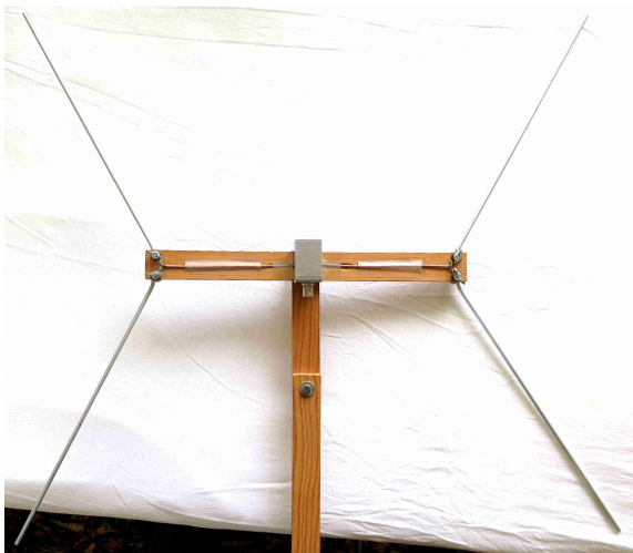
Photo 10 : Fouets inclinés de 30° par rapport à la verticale pour améliorer la réponse en bas de bande
