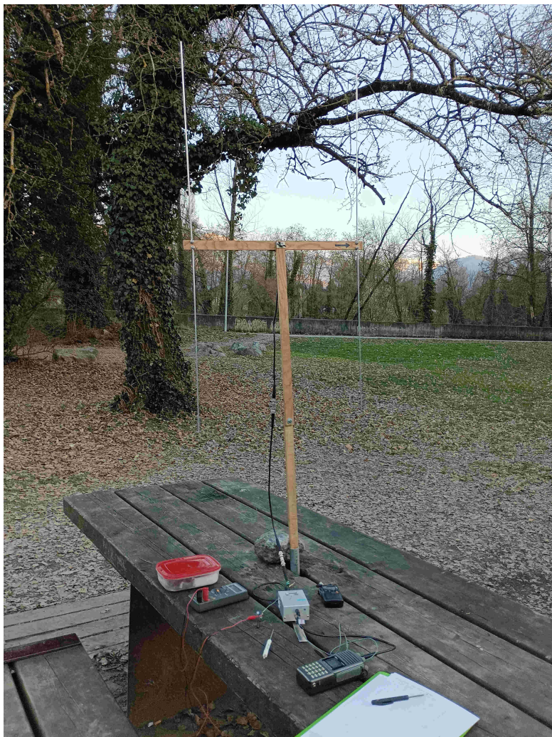
Photo 1 : Essais du HTB en Homing sur balise 121,5 MHz
