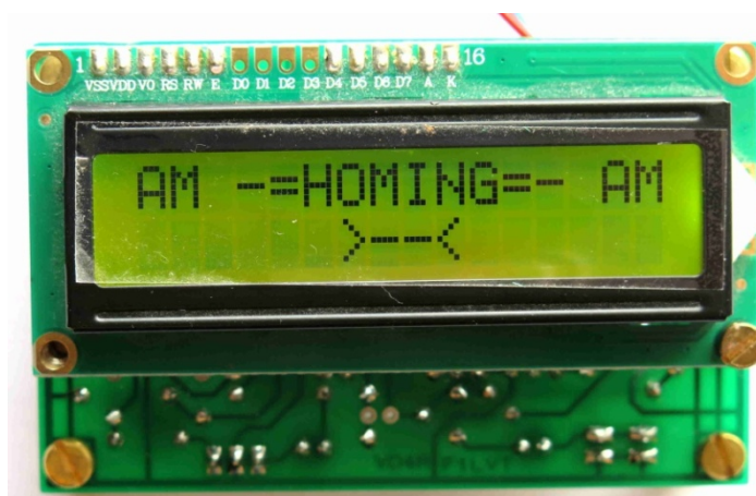
Photo 1 : Le « Homing Toutes Bandes » numérique avec son afficheur LCD en position « Homing AM »
