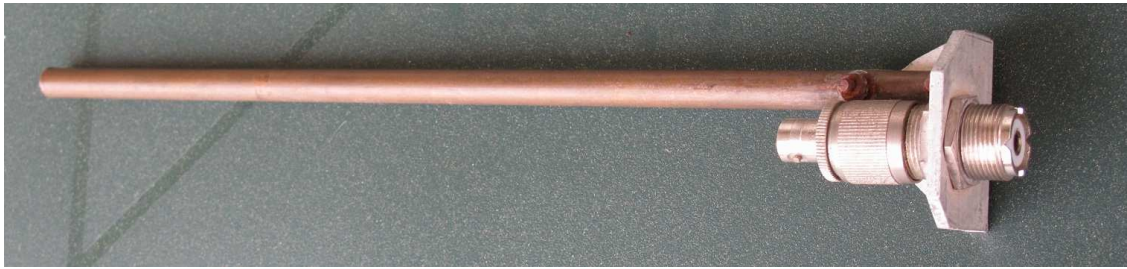
Photo 2 : Montage du support d'antenne sur le tube vertical
