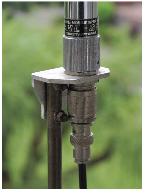
Photo 3 : La fixation de l'antenne
