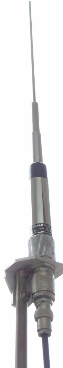
Photo 1 : Antenne demi-onde au bout du mât télescopique
