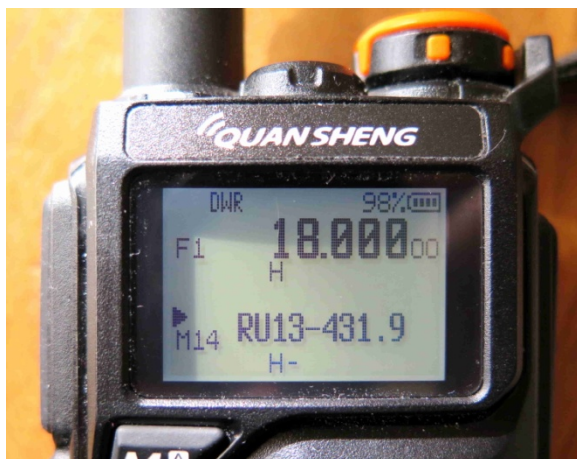
Photo 2 : La fréquence de réception commence à 18 MHz
