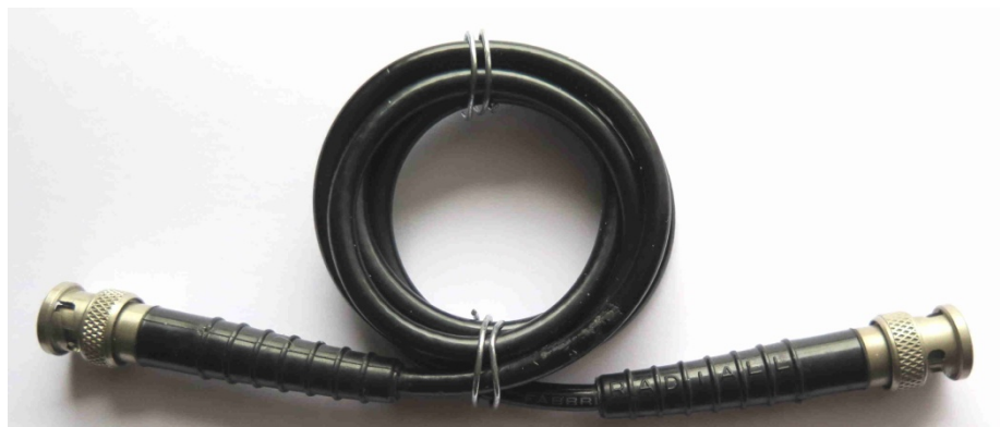
Photo 2 : Inductance série pour réduire le courant de gaine. Elle est constituée de 5 spires de 5 cm de diamètre environ.
