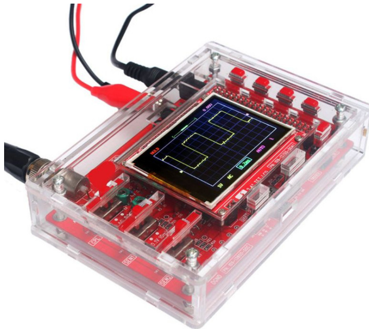
Photo 1 : Oscilloscope DSO 138 avec son boîtier acrylique transparent.
