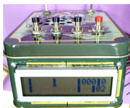
Montréal 2 / PIC 16F877 Direction et menus sur afficheur à 2 lignes
