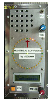
Montréal 3V2 / 3 PIC Afficheur à 2 lignes pour les menus Direction par 36 LED
