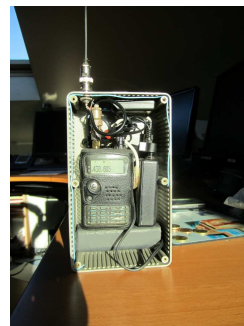
Balise d'exercice de l'ADRASEC78 (F5GPO) En haut l'antenne avec quelques radians internes à la boîte et à droite la platine GPS. En dessous le THF7 (sur 430.005) et le générateur de trames. En bas la batterie 9v6 pour le générateur et le GPS
