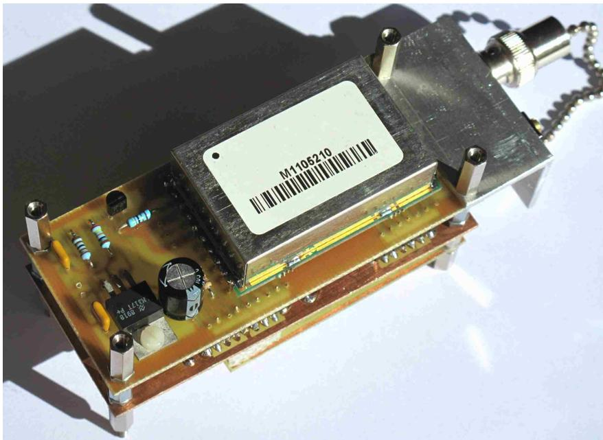
Photo 1 : Balise 406 vue côté module émetteur
