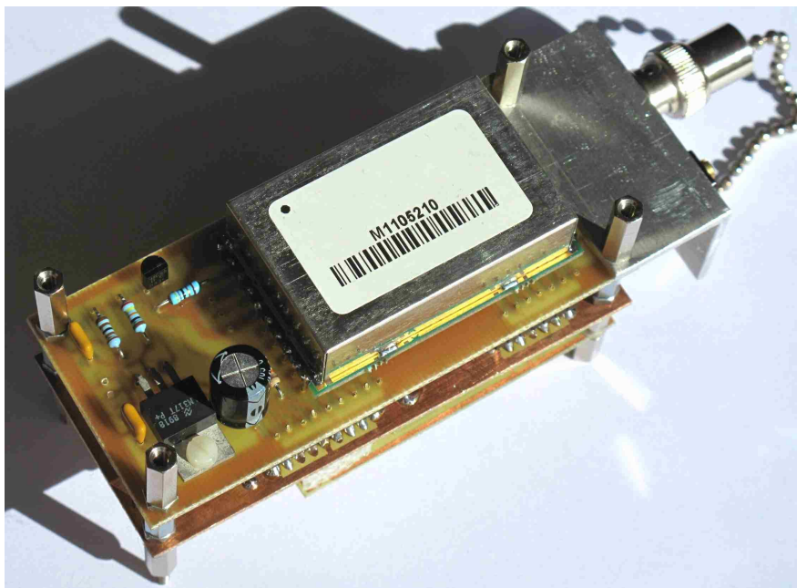
Photo 1 : Balise 406 vue côté module émetteur
