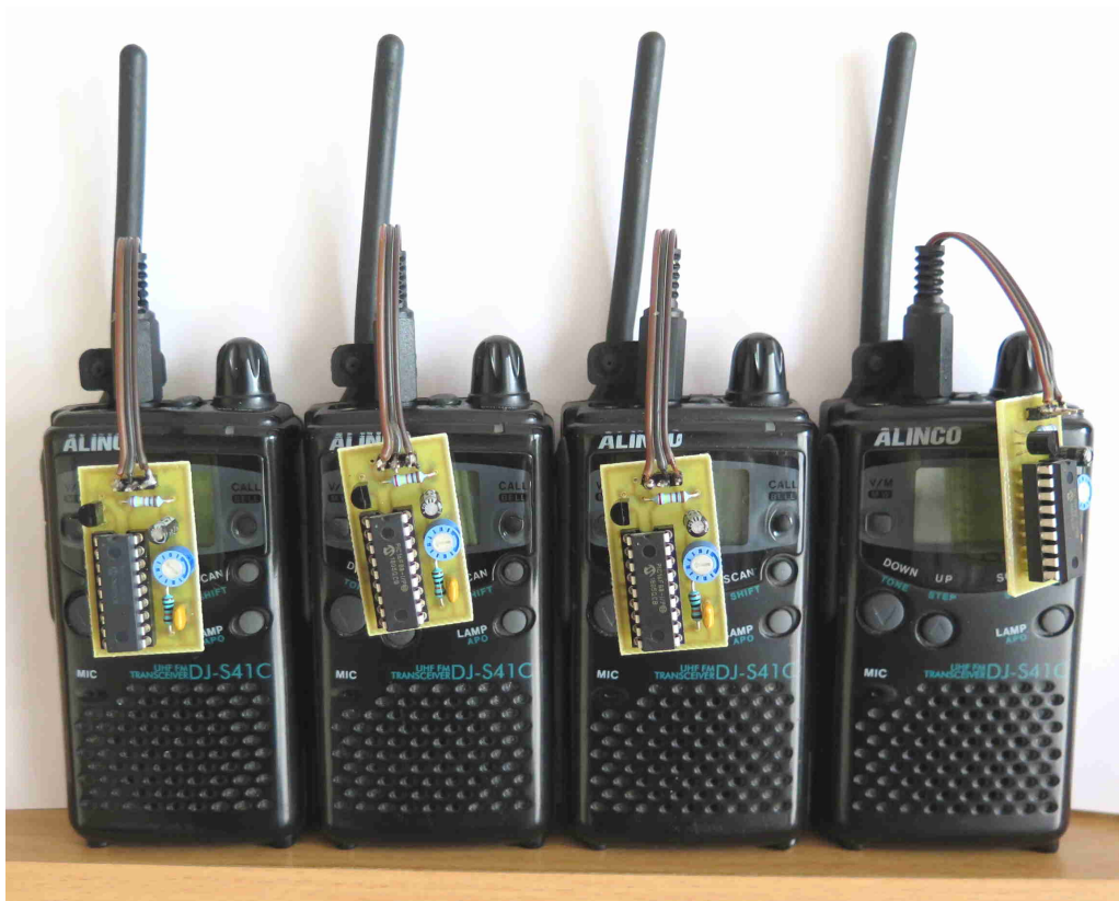
Photo 4 : Construction en petite série de la mini-balise de test 406
