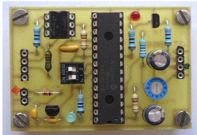
Photo 1 : Générateur de trames fonctionnant avec un PIC 16F886
