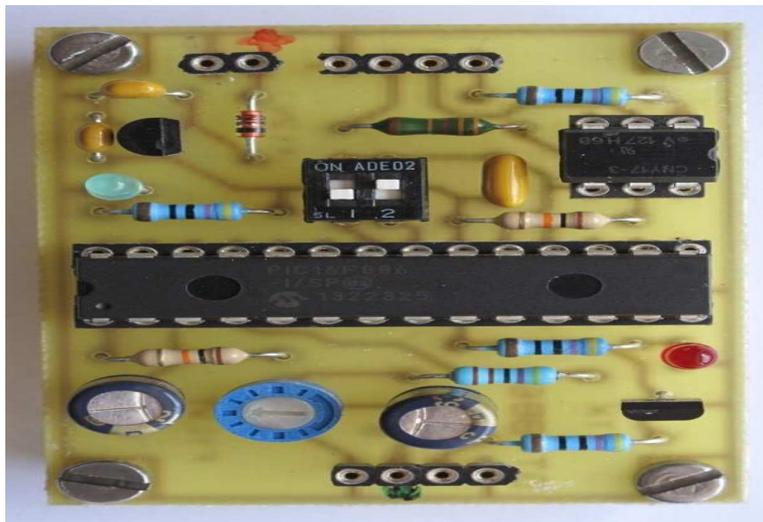
Photo 1 : Générateur de trames réalisé avec un PIC 16F886
