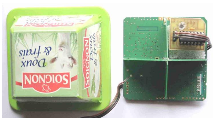
Photo 10 : Le GPS et son antenne entrent dans une boîte de fromage de chèvre en rognant très légèrement les bords latéraux de l'antenne
