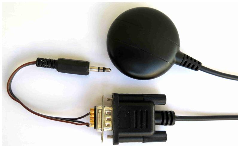
*Photo 3 : Connexion du GNSS par un Jack 3,5 mm*
