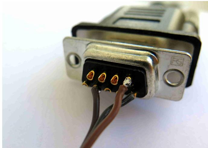
*Photo 2 : Connexion du GNSS sur la DB9*
