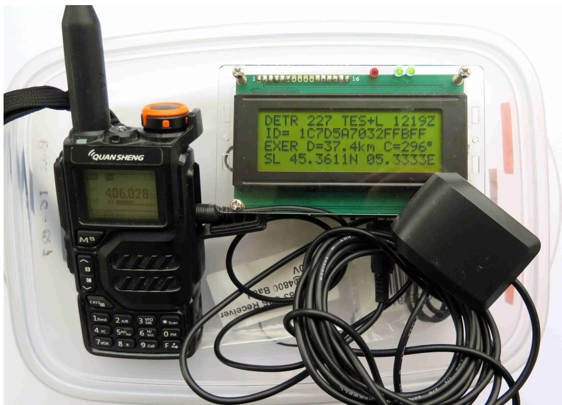
Photo 2 : L'ensemble « UV-K5 – décodeur DECTRA – GPS » en fonctionnement
