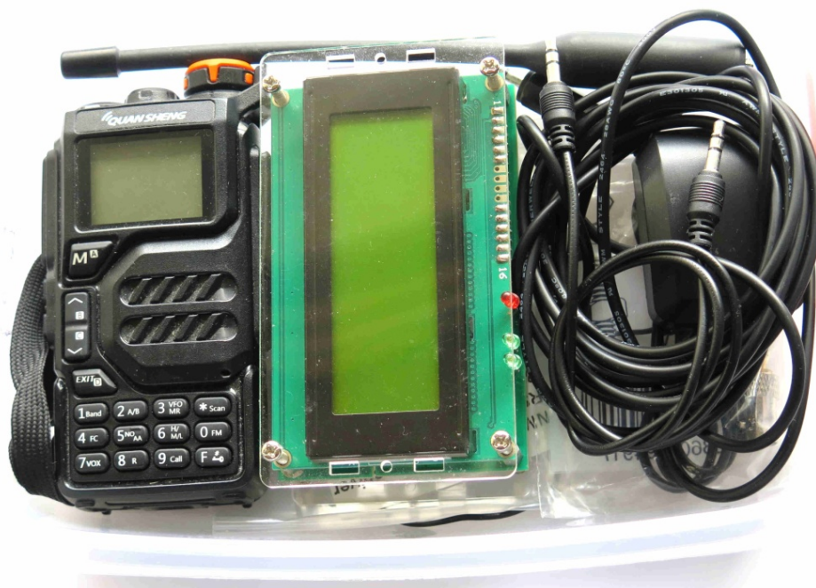
Photo 1 : La boite est prete a partir pour un SATER : UV-K5, decodeur DECTRA et GPS
