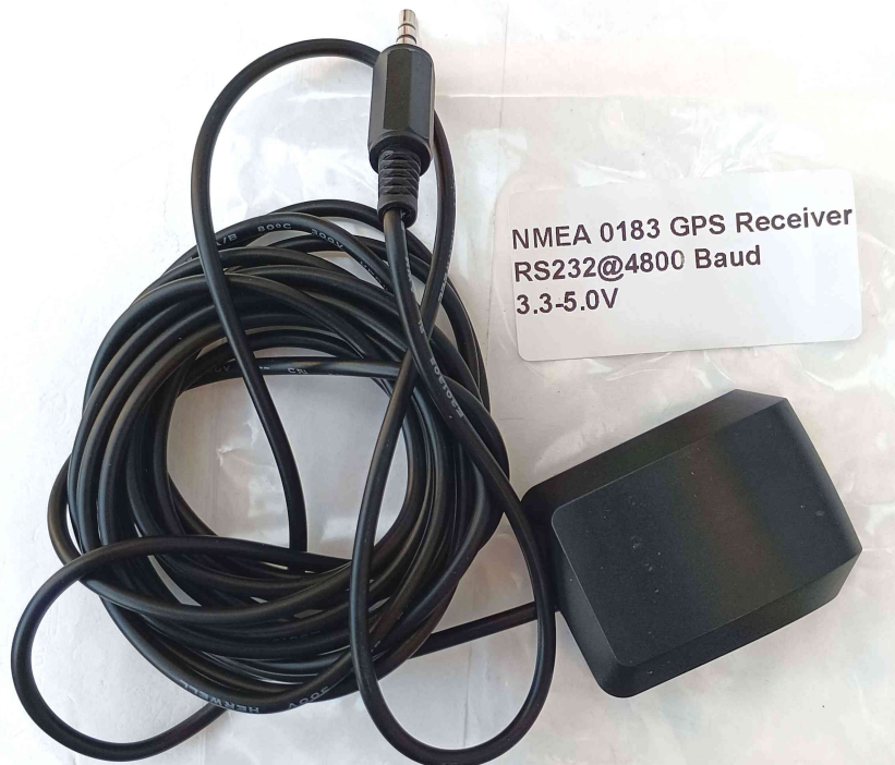
Photo 2 : GPS à 4800 bd, avec un connecteur jack 3,5 mm stéréo
