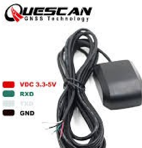
Photo 1 : GPS en 4800 bauds alimenté entre 3.3V et 5V
