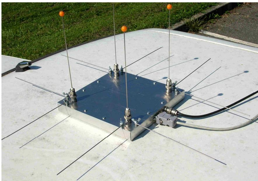
*Photo 1 : Antenne Doppler UHF. L'antenne est reliée au boîtier Doppler par 2 câbles :
