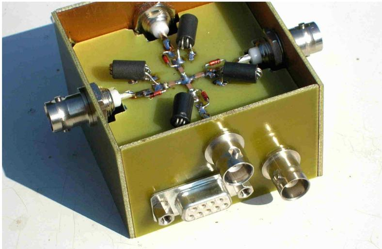
*Photo 3 : Le boîtier de commutation d'une antenne Doppler VHF.*
