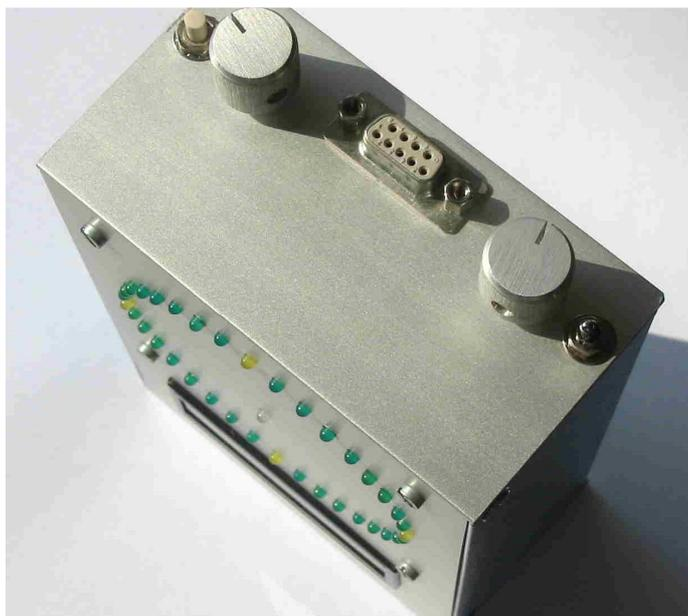
Photo 2 : Boitier Doppler avec le connecteur DB9 pour envoyer les signaux de commutation vers l'antenne.
