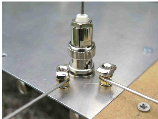
*Photo 8 : Les tiges qui servent à étendre le plan de masse sont la serrées par des écrous M3 pour profilés 2020*
