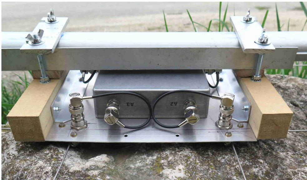
*Photo 10 : L'antenne 406 et la barre de toit retournées, sans les fouets mais avec les brins de masse déployés*
