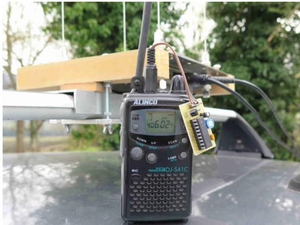
*Photo 13 : Petite balise 406 utilisée pour l'alignement du Doppler dans l'axe du véhicule, puis pour vérifier et valider le fonctionnement du Doppler.*
