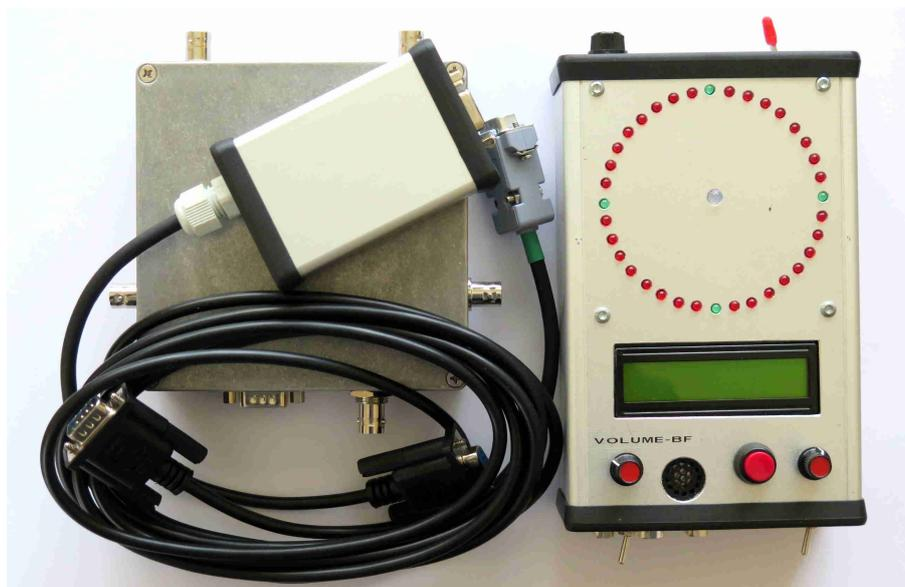
*Photo 2 : Le « Doppler Montréal 3V2 AD45 » : le boîtier principal, l'interface, le commutateur et le câble de liaison DB9*
