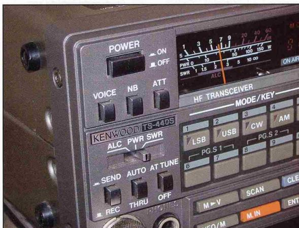
10 - Dans l'angle supérieur gauche de la façade, proche du BP de mise en route, se trouve le BP "Voice". Si l'option VS1 (Voice synthesizer) n'est pas montée, ce bouton-poussoir est disponible pour piloter le DSP.
