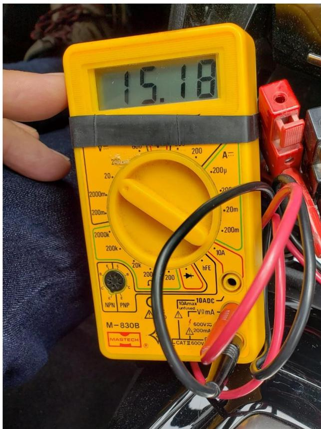
*Photo 1 : Mesure de la tension batterie à 15,18 V, ce qui est nettement trop élevée !
