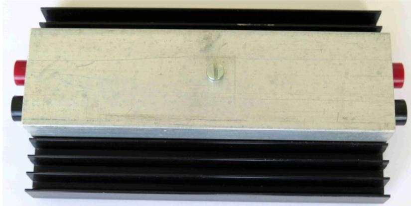
*Photo 3 : Stabilisateur de tension 12,6 V. Le boîtier est refermé par un tronçon de U en dural de 40 mm de large et 140 mm de longueur*
