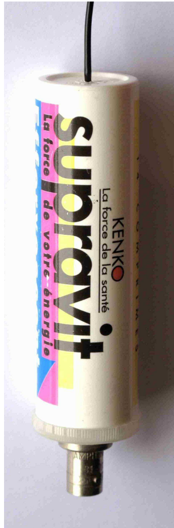
Photo 3 : Le système d'adaptation est protégé par un tube de vitamines (!)
