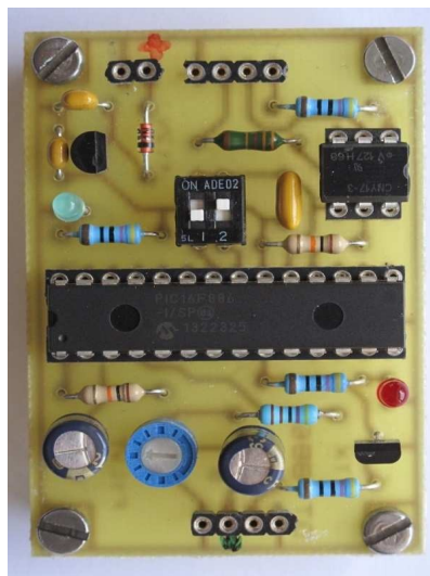
Photo 1 : Générateur de trames avec un PIC 16F886
