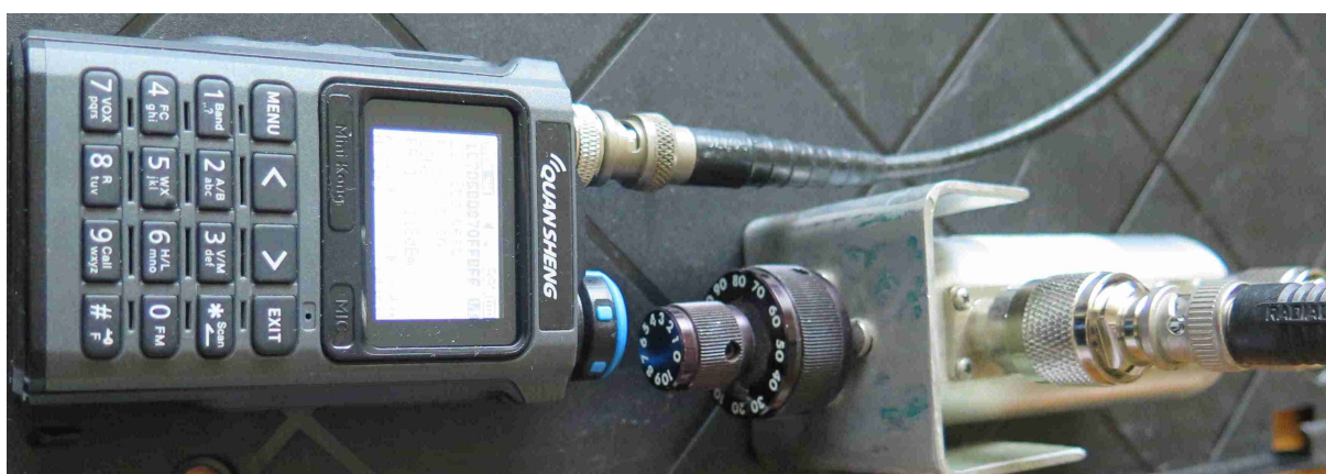
Photo 5 : Mesure de la sensibilité de la réception en décodage. L'atténuateur permet de réduire le signal jusqu'au point de non – décodage.
